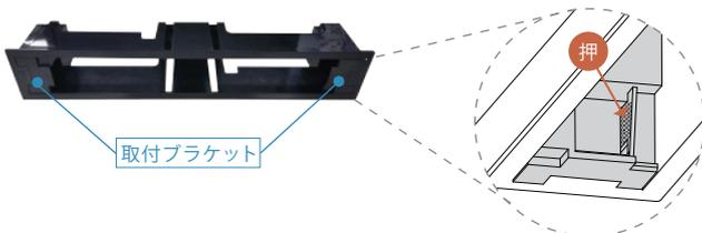
まず外筒からセンサー本体を取外します。次に左図の矢印の指す面を押すと爪が外れ、取付ブラケットを取外することができます。
